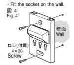
図 5 Fig. 5 ご注意 Note: この範囲内が平坦な壁面に コンセントを取り付ける。 注)取付前に必ず確認してください。 Fit the socket on the wall with flat surface. Be sure to check the wall face before
