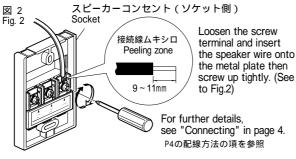
注)ねじターミナルのねじは3回転以上ゆるめない。 ねじがはずれてターミナル部脱落の原因になります。
